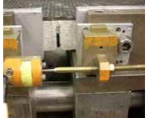
Il test di impermeabilità sotto pressione pulsante
