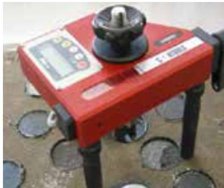
Per valutare la qualità della posa in opera il test viene condotto anche in cantiere con un dinamometro manuale
