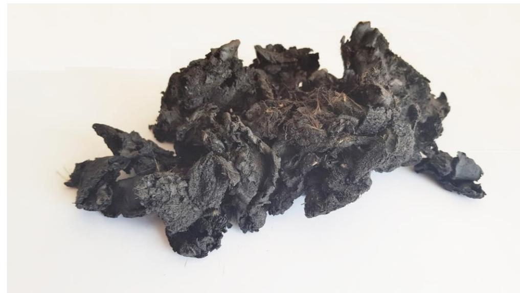
Materiali provenienti dalla demolizione dei tetti o dagli sfridi di produzione delle membrane in stabilimento. Contiene filler, polimeri e materiali inerti e un contenuto di bitume molto elevato intorno al 50%.
