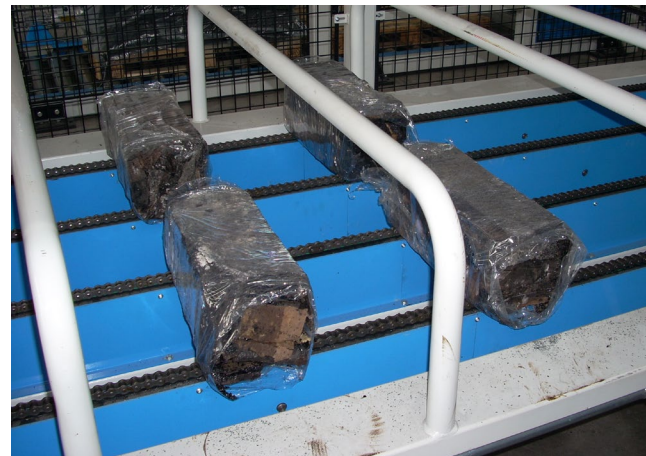
ESEMPIO DI RIFIUTO DA TEGOLE BITUMINOSE
