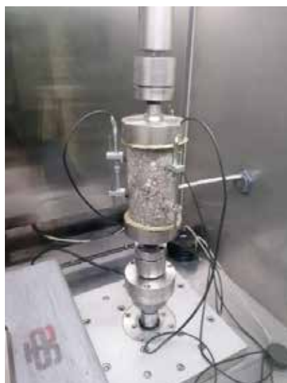
Fig. 6 Configurazione di prova delle prove di modulo complesso
