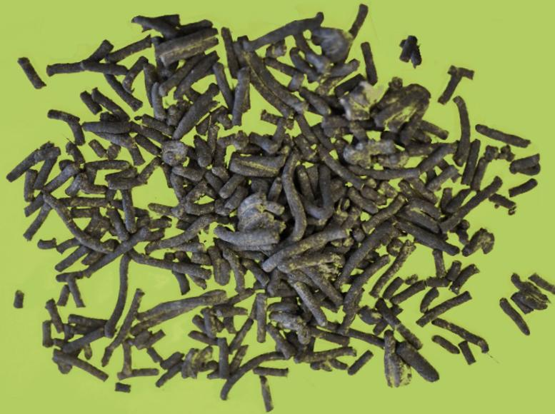
I granuli ottenuti dalla macchina sono convenientemente granuli riciclabili di spessore ridotto, che sono adatti ad essere usati in un successivo processo per realizzare nuovi prodotti in materiale bituminoso, quali ad esempio i prodotti a base di bitume utilizzati nel settore edile ai quali sono associati gli scarti sopra citati.
